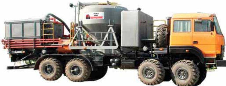
Монтажная база – автомобильное шасси Урал 532362-1022-10 (двигатель «Евро-2») Assembly base - automobile chassis the Urals 532362-1022-10
