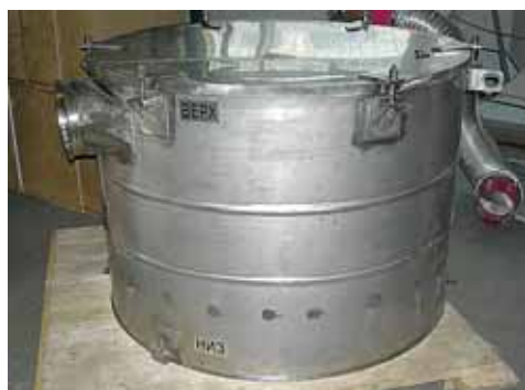
Фильтр-адсорбер АУИ со сменным сорбирующим картриджем
