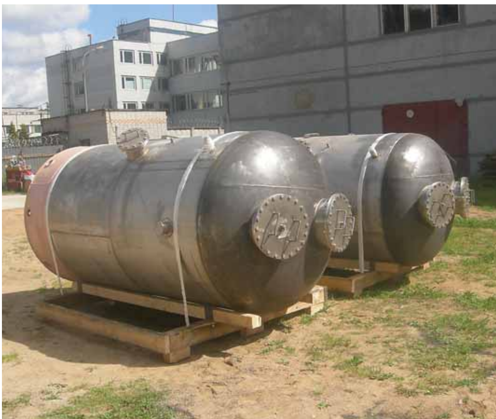
Фильтры-адсорберы ФАУ-65 с угольной насадкой для очистки технологических выбросов АЭС
