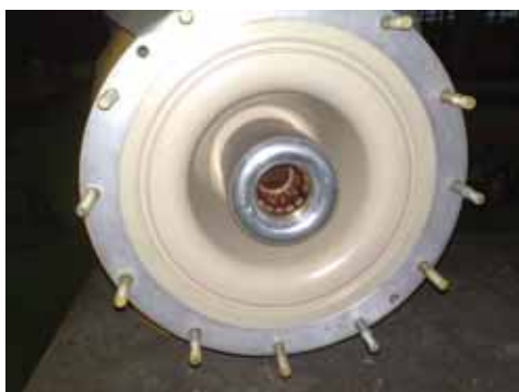
Изолятор из компаунда
