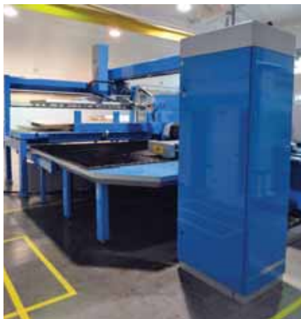
Рис. 3. Координатно-револьверный пресс комбинированный с манипулятором Fig. 3. Combined coordinate turret press with a manipulating device
