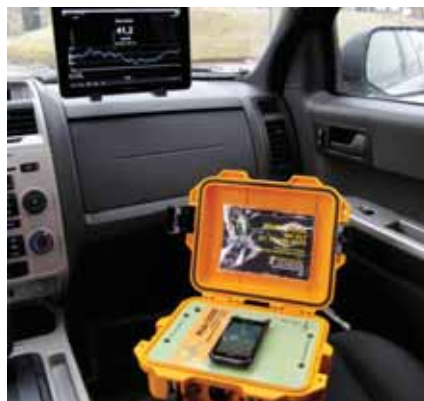
Рис. 2. Мобильная система радиационного мониторинга Mob-DOSE, установленная в автомобиле / Mobile system Mob-DOSE for radiation monitoring installed in a car
