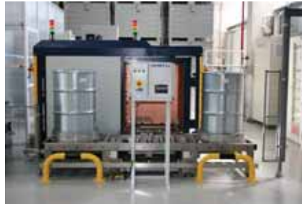
Рис. 1. Стационарная система для гамма-спектрометрических измерений РАО на АЭС «Игналина» (Литва) / Stationary system for gamma spectrometry measurement of radwaste at Ignalina NPP (Lithuania)
